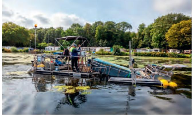
Bild 5.30: Prototyp eines Rollenpflückers bei seinem testweisen Einsatz auf dem Baldeneysee
