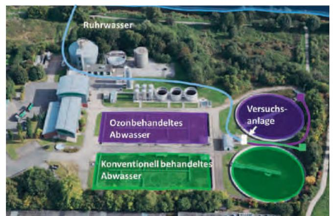
Bild 11.1: Kläranlage Schwerte mit Lage der Versuchsanlage und Entnahmestellen der Versuchswässer
