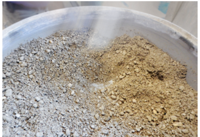
Das erdfeuchte Betonmischgut im Labor
