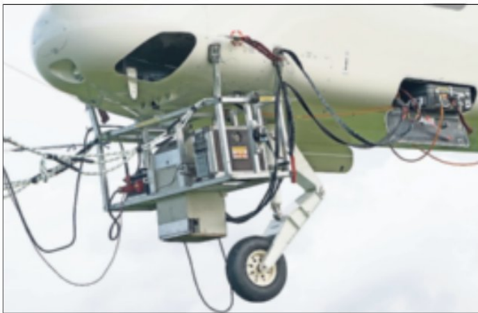
Die Box mit den Messgeräten wird unterhalb der Passagierkabine angebracht. Gemessen werden Spurengase und Feinstaub.
