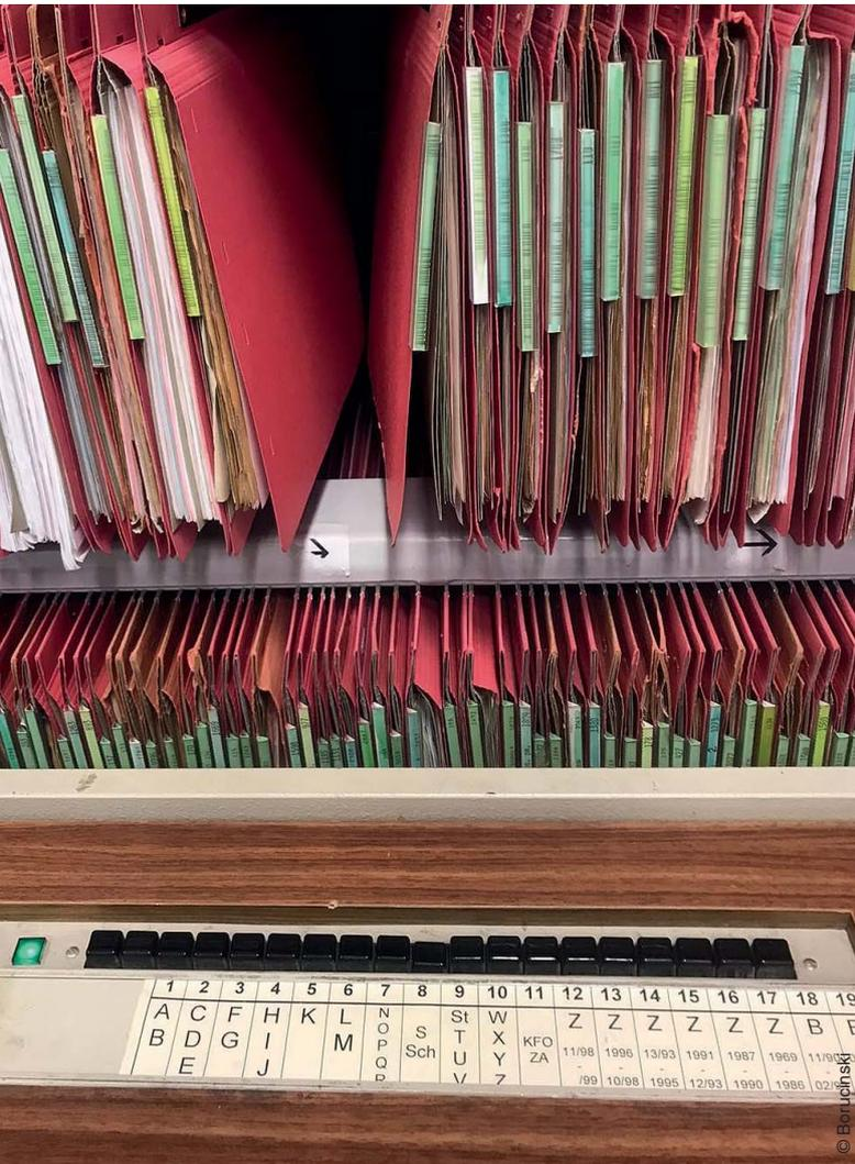
Das Akten-Paternostersystem nach dem Prinzip des Paternosteraufzugs ermöglicht eine kompakte Lagerung von Akten.
