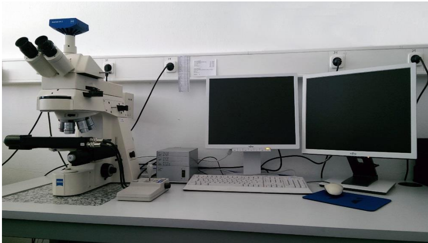
Abbildung 4-5: Auflichtmikroskop Axioplan 2 der Firma Carl Zeiss AG.
