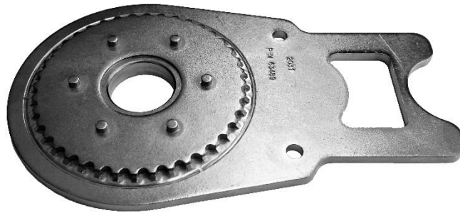
Abbildung 1-1: Blechbauteil einer Sitzverstellung mit Durchsetzungen.
