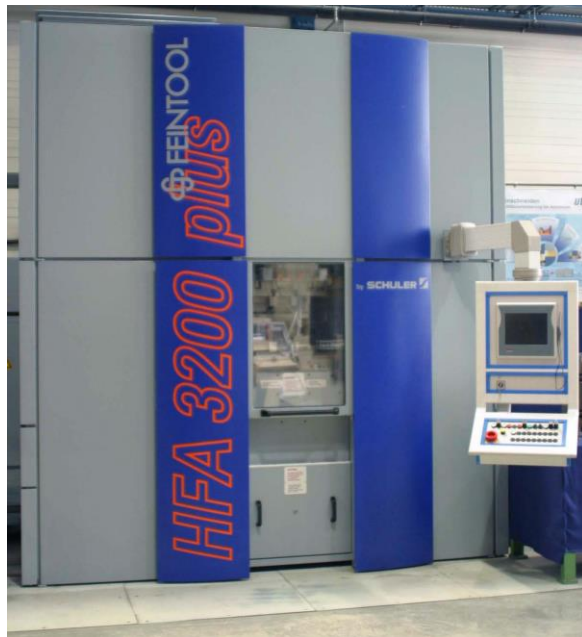
Abbildung 4-1: Feinschneidpresse Feintool HFA 3200 plus Figure 4-1: Fineblanking press Feintool HFA 3200 plus
