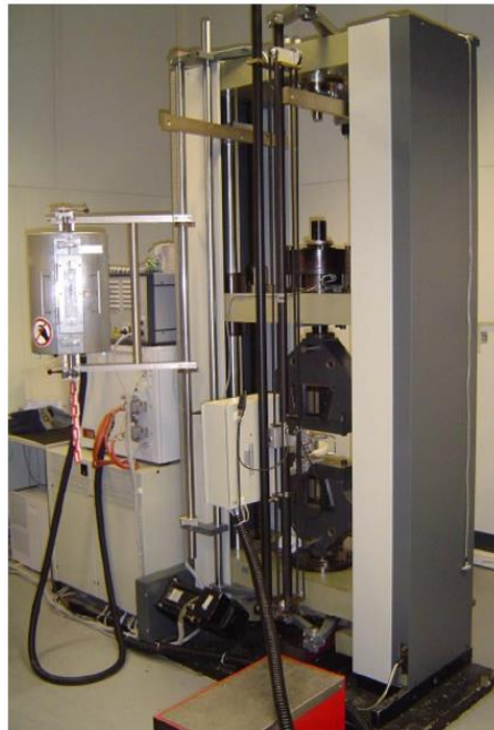
Abbildung 4-7: Universal Zug-Druck-Prüfmaschine 1484/DUPS-M der Firma Zwick GmbH & Co. KG.
