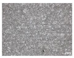
Abbildung 5 Schliffbilder der verwendeten Grundwerkstoffe S355J2 (links) und S960QL (rechts). Ätzung Nital
