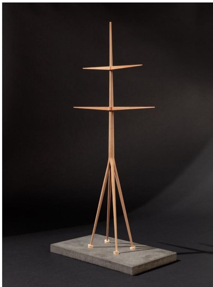
Abbildung 4-26: Modell Variante 4: Vollwandrohr konisch Vierfußsockel, Traverse aufgesteckt
