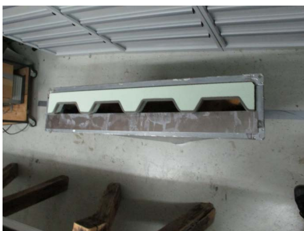
Abbildungen 5-7: Bau von SEA 2.1: Herstellung und Anpassung der Luftanschlüsse Figures 5-7: Construction of SEA 2.1: Production and fitting of the air connection
