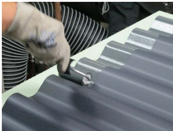
Abbildung 5-17: Bau von SEA 2.3: Lackieren des Absorbers mit RAL 7016
