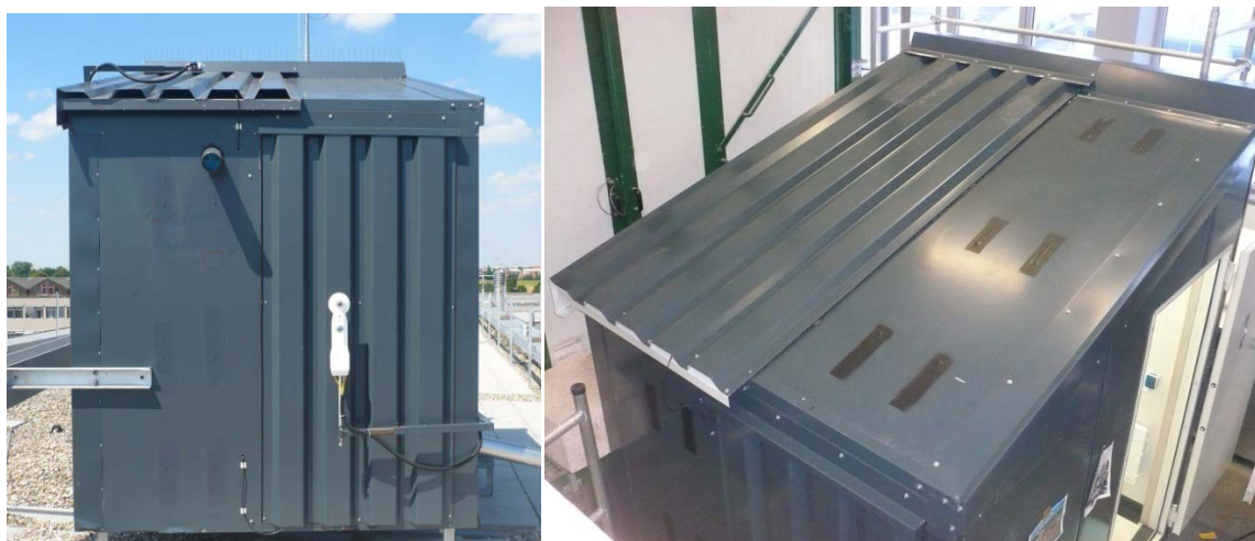
Abbildung 2-5 (linkes Bild): Foto der SEA-Messzelle auf dem Dach des FIW; Ansicht Südseite; SEA-Wandkollektor (rechts) mit Referenz Sandwichelement (links)
