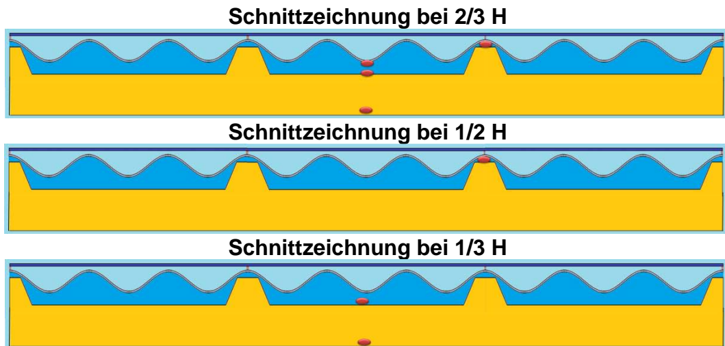
Abbildung 5-32: Positionen der Temperatursensoren im SEA-Kollektor 2.3 abhängig von der Höhe im Kollektor
