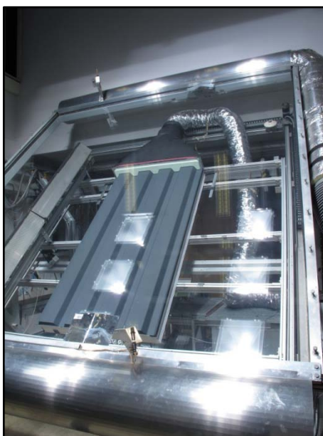
Abbildung 5-8: SEA-Kollektor 2.1 im Solarsimulator (Teststand) des Fraunhofer ISE
