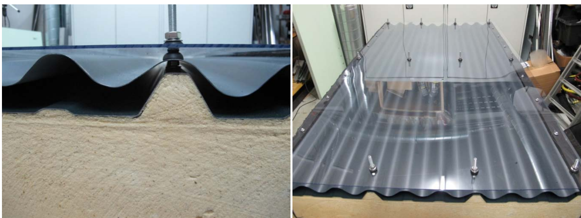
Abbildungen 5-21: Konstruktion des SEA-Kollektors 2.3 Figures 5-21: Finished SEA collector 2.3
