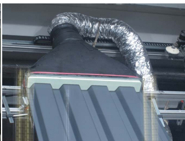
Abbildungen 5-7: Bau von SEA 2.1: Herstellung und Anpassung der Luftanschlüsse Figures 5-7: Construction of SEA 2.1: Production and fitting of the air connection
