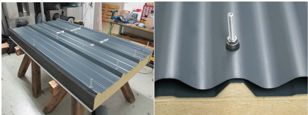
Abbildungen 5-18: Bau von SEA 2.3: Sandwichelement mit 12 montierten Solarbefestigern und eingebauten Temperatursensoren sowie Nahaufnahme der Befestigung des Absorber-Wellenprofils mit einer Glockendichtung
