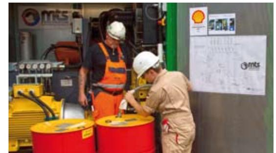
Für den Steuerstand einer Vortriebsmaschine wird ein spezielles Hydrauliköl verwendet.
