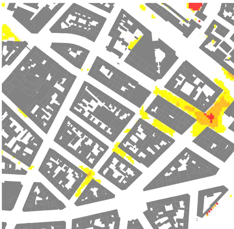
Überflutung nach Starkregen (T=50a) maximaler Wasserstand (m)
