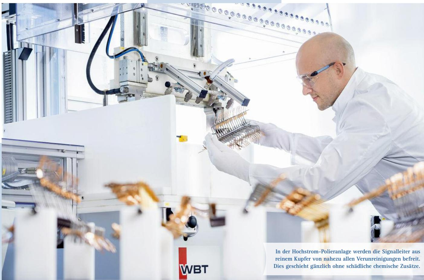
In der Hochstrom-Polieranlage werden die Signalleiter aus reinem Kupfer von nahezu allen Verunreinigungen befreit. Dies geschieht gänzlich ohne schädliche chemische Zusätze.
