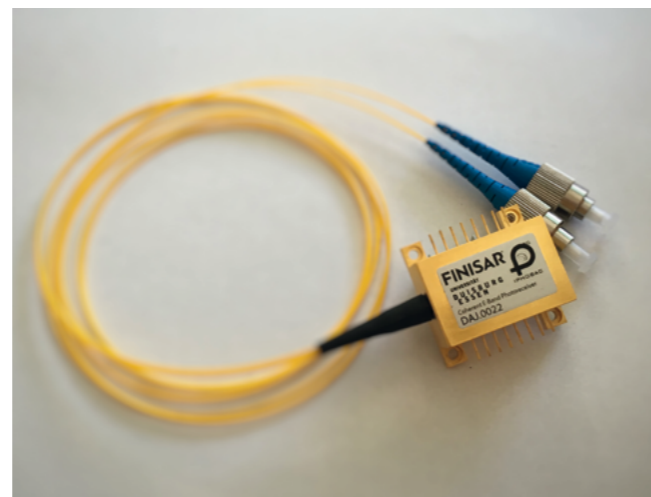
In Kooperation mit FINISAR entwickelter Kohärenter Photonischer Mischer (CPX) für eine spektral effiziente Radio-over-Fiber-Kommunikation Coherent photonic mixer (CPX), developed with FINISAR for spectrally efficient radio-over-fiber communication
