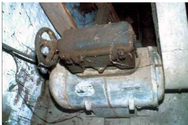
Bild 12: Drei-Phasen-Elektromotor mit 15 kW (20 PS) Leistung, Fabrikat: 'Brunken DOKAMOTOR' mit Sterndreieckschaltung. Geschaltet wurde der sogenannte Ringschleifer über ein Handrad.
