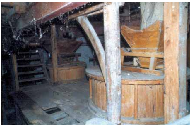
Bild 7: Blick von hinten auf Mahltisch mit Schrot-(NiG2) und Weizen-(NiG1)gang. Im Bild vorne der 'Galgen' zum Anheben der Läufersteine zum Schärfen von Bodenstein und Läuferstein.
