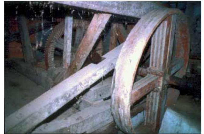
Bild 19: Transmission (NiG5.3), linke Riemenscheibe für Antrieb des Sackaufzuges. Mittlere Riemenscheibe, Durchmesser 220 cm, wird von der Transmission (NiG5.2) angetrieben. Rechte Riemenscheibe für Antrieb einer Maschine außerhalb der Mühle, z.B. eine Strohhäckselmaschine oder eine kleine Dreschmaschine.
