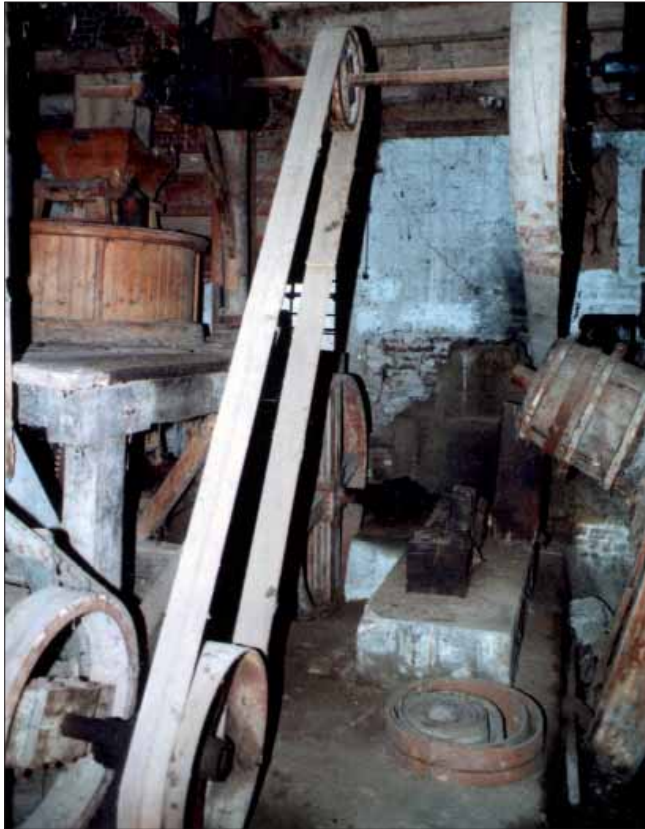
Bild 16: obere Transmission (NiG5.1) auf Schrotgangantrieb (NiG6.2) und unten links: Antriebsrad für 3. Transmission (NiG5.3).
