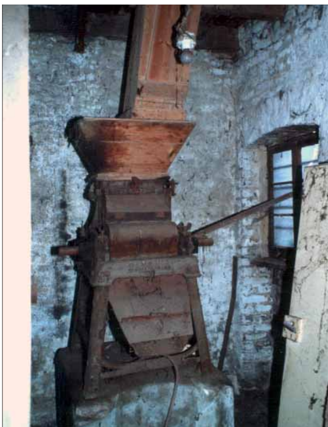
Bild 8: Quetschstuhl (NiG4) Fabrikat SAXONIA mit zwei gegeneinanderlaufenden gleich großen, leicht geriffelten Walzen zum Quetschen von Hafer für Futterzwecke und von Roggen zum besseren Vermahlen (bessere Mehlausbeute).
