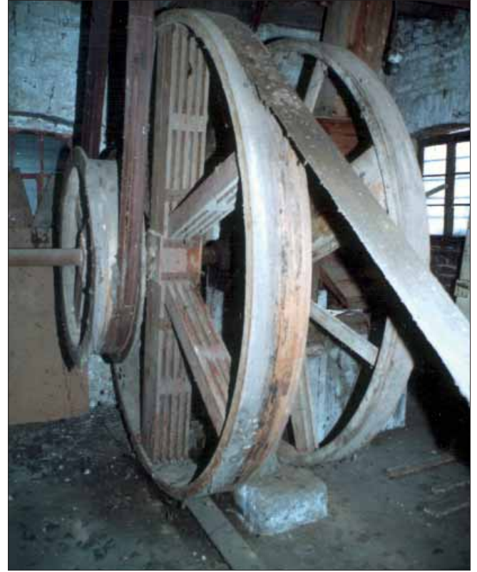
Bild 19: Transmission (NiG5.3), linke Riemenscheibe für Antrieb des Sackaufzuges. Mittlere Riemenscheibe, Durchmesser 220 cm, wird von der Transmission (NiG5.2) angetrieben. Rechte Riemenscheibe für Antrieb einer Maschine außerhalb der Mühle, z.B. eine Strohhäckselmaschine oder eine kleine Dreschmaschine.
