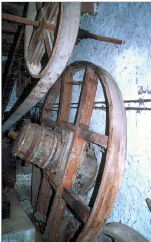
Bild 10: Antrieb der ersten Transmission (NiG 5.1).
