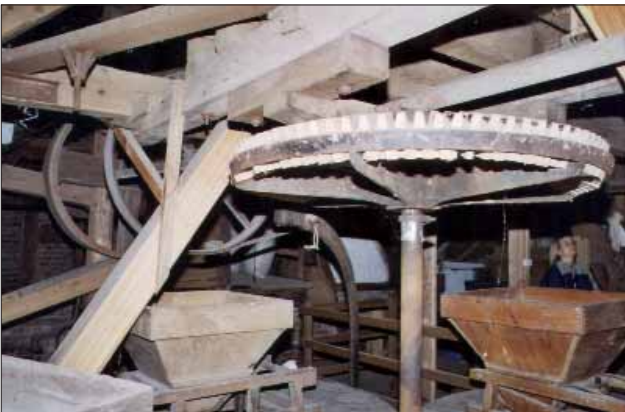
Bild 13: Tellerrad für die Kraftübertragung auf die Transmission.
