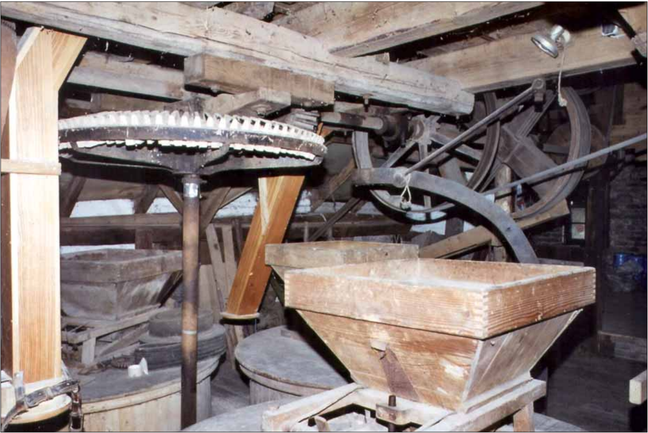
Bild 12: Antrieb (Teller- und Kegelrad) für Transmission (NiG4) im Obergeschoss.
