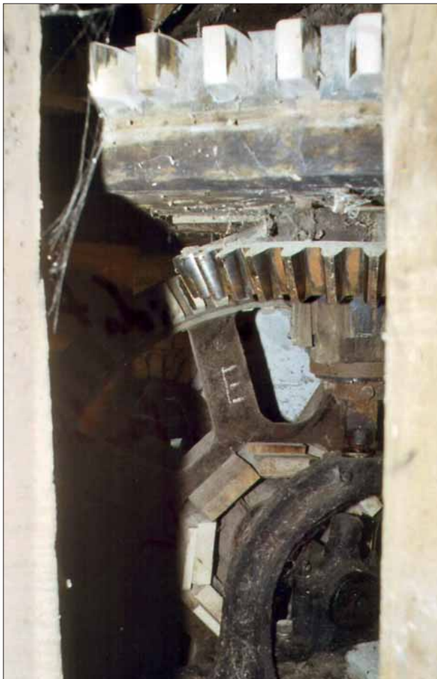
Bild 2: Stehendes Zeug; hinten: Tellerrad auf der Wasserwelle (NiG5); mittig: Kegelrad (NiG6), oben: großes Kammrad (NiG7).
