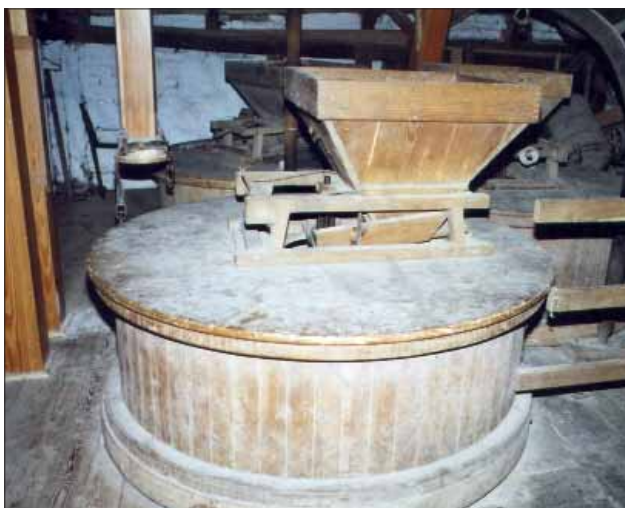
Bilder 10/11: Roggenschrotgang (NiG1): Bütte, Rüttelschuh und Trichter.
