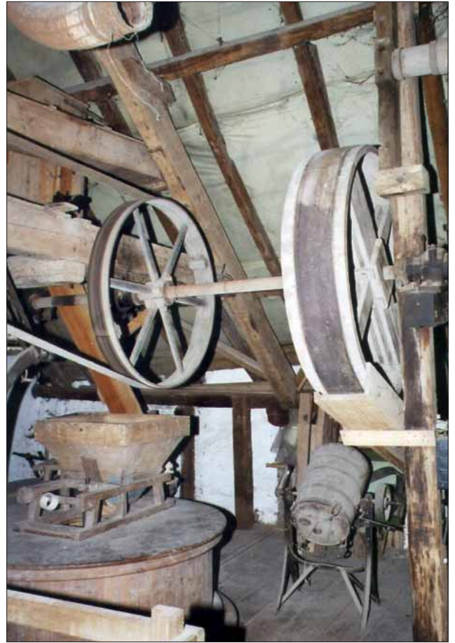
Bild 7: Steinboden: Weizenmahlgang (NiG3) und Transmission.
