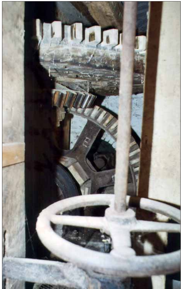
Bilder 3/4 und 5: Stehendes Zeug (Teilansicht); Handrad zur Mahlrad-Einstellung des Schrotganges (NiG 2).
