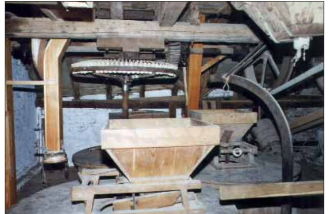
Bild 9: Teller- und Kegelradgetriebe (NiG4) für die Steinboden-Transmission.
