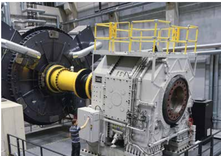
Am hellgrauen Ende des Prüfstands werden die Windgondeln angedockt. Der Prüfstand simuliert dann die Kräfte, die auf eine Windenergieanlage im Betrieb wirken. Mithilfe von Messergebnissen können die Forscher so wichtige Erkenntnisse gewinnen. Siehe auch die Skizze auf der nächsten Seite.
