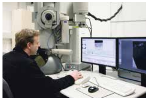
Dr. Christoph Somsen, Akademischer Oberrat am Institut für Werkstoffe, kann sich auf die präzisen Ergebnisse des Transmissions-Elektronenmikroskops verlassen - auch dank eines entkoppelten Betonfundaments, elektrischer Spulen in den Wänden und einer speziellen Lüftungsanlage.
