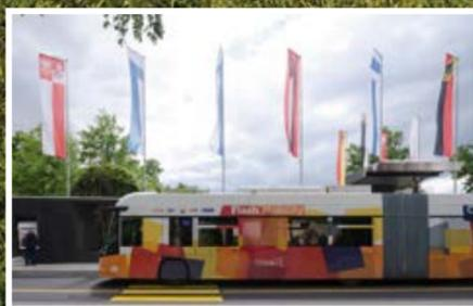
In Genf fährt der erste rein elektrisch betriebene Gelenkbus, der mit ABB-Technologie ohne Oberleitung auskommt. 15 Sekunden reichen, um den Bus an jeder dritten oder vierten Haltestelle aufzuladen.
