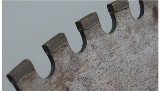
**Kleben statt Hartlöten. Das funktioniert auch bei den Zähnen dieses Schneideblattes, das für die Bearbeitung von Stein verwendet wird.**
