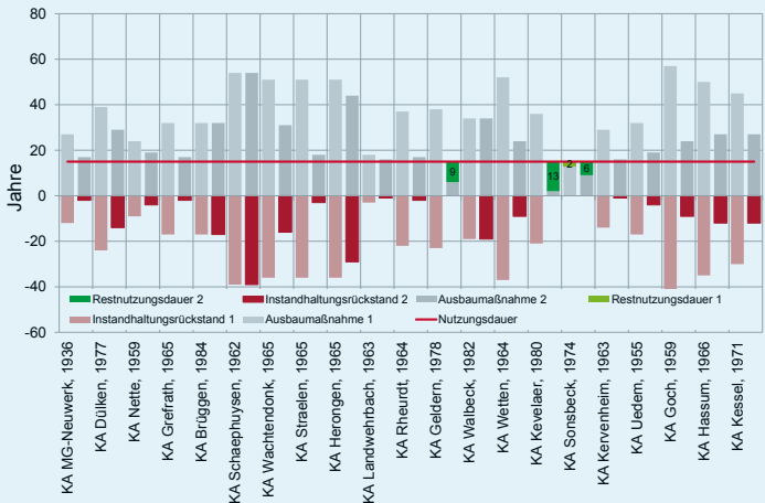
Zustandsbewertung am Beispiel Elektrotechnik - Nutzungsdauer Kläranlagen; Reinvestition nach rund 15 Jahren
