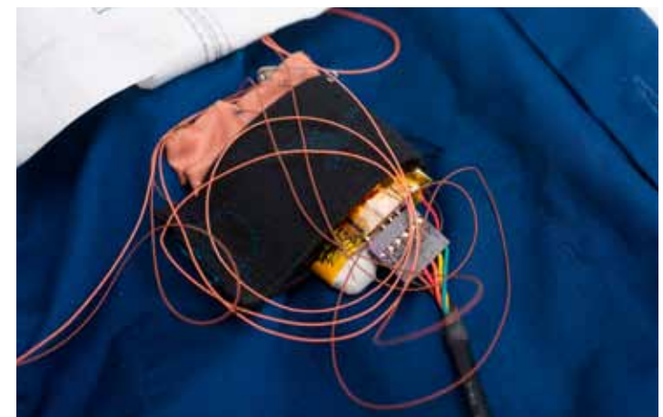
Sensoren im Hemdkragen (l.) und ein flacher Mini-Computer in der Hemdtasche (oben und r.): So sieht das Hemd der Zukunft aus.
