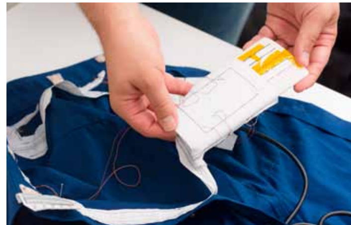
Sensoren im Hemdkragen (l.) und ein flacher Mini-Computer in der Hemdtasche (oben und r.): So sieht das Hemd der Zukunft aus.
