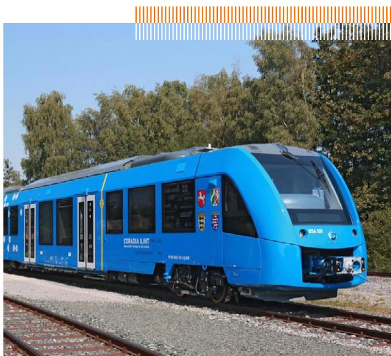
Brennstoffzellantriebwagen Alstom Coradia iLint
