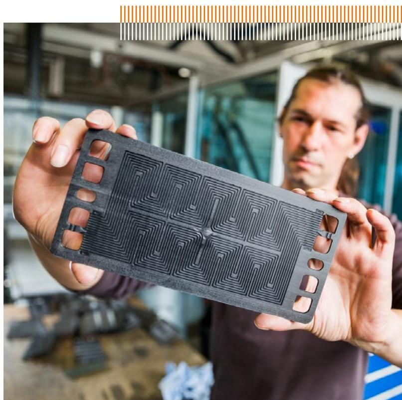
Spritzgegossene Bipolarplatte für HT-PEFC
