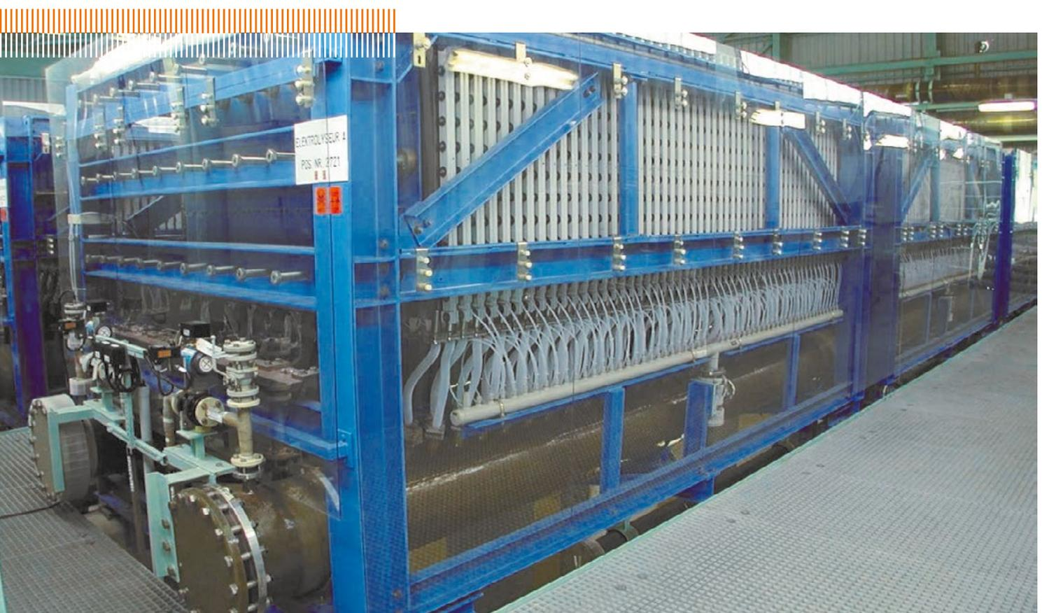
Chlor-Alkali-Elektrolyse in Hürth-Knapsack: 310.000 t Chlor pro Jahr, 203.000 Nm<sup>3</sup> Wasserstoff pro Tag
