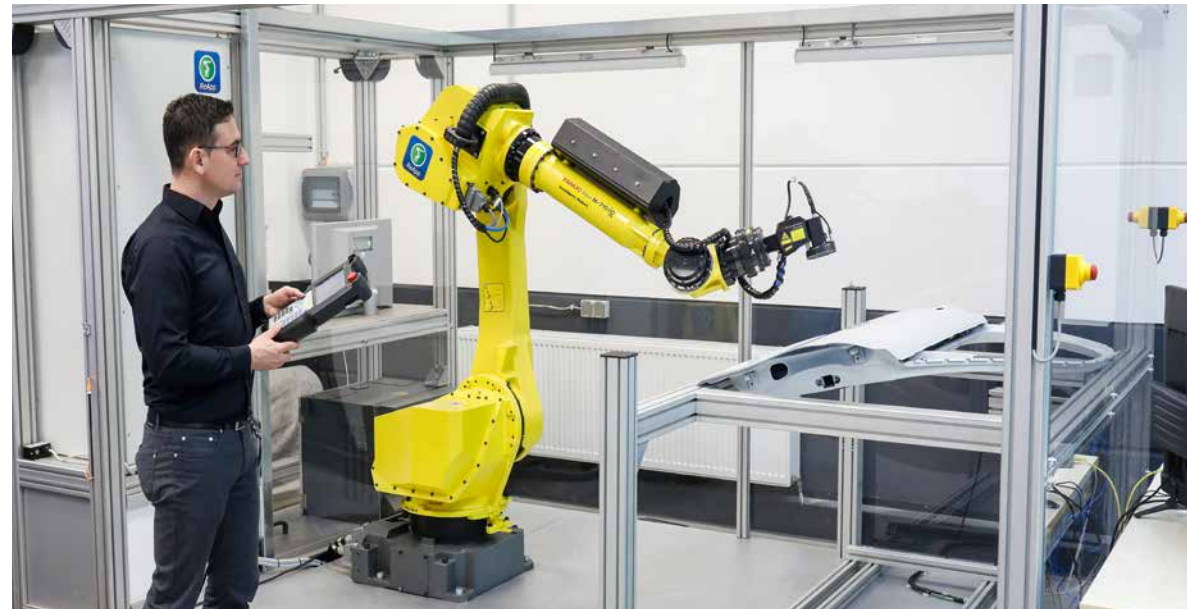
Geschäftsführer Daniel Bunse programmiert den Industrieroboter eines intelligenten Inspektionssystems zur Schadensdetektion auf nahezu beliebigen Bauteilen.
