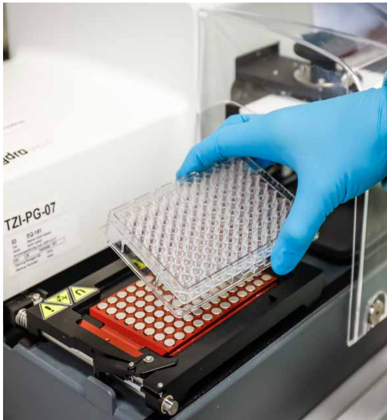
Waschautomat zum Aufreinigen von Beads im Hydro Speed Microplate Washer
