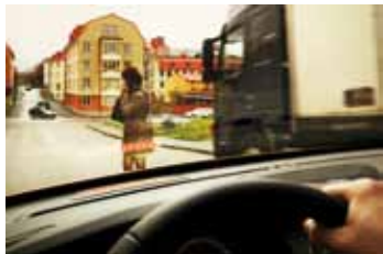
Volvo S60/V60. Fußgänger-Erkennung mit automatischer Vollbremsung. In einer Gefahrensituation erhält der Fahrer ein akustisches Warnsignal in Kombination mit einem Blinklicht im Head-up-Display der Windschutzscheibe. Das System kann Kollisionen mit Fußgängern bis zu einer Geschwindigkeit von 35 km/h verhindern.
