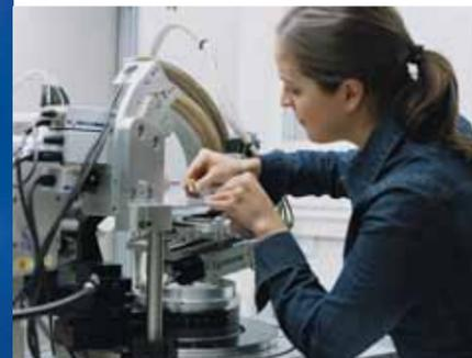
*Helen Blomqvist analysiert im Coromant Forschungslabor mit einem hochentwickelten Röntgendiffraktometer kristalline Strukturen in unbekanntem Materialproben.*
