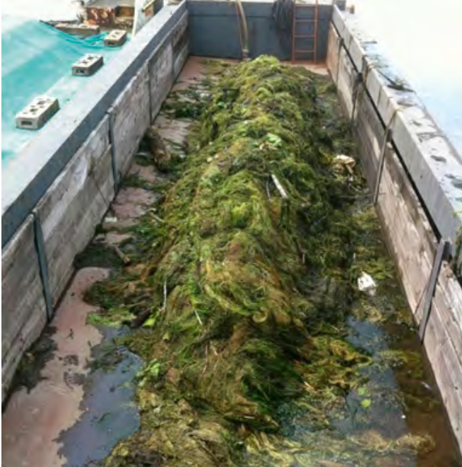
Bild 5.24: Entnommene Makrophytenmenge nach zweitägigem Hydroventuri-Einsatz. Das Material ist ein Gemisch aus Wasserpflanzen, Steinen und Müll.
