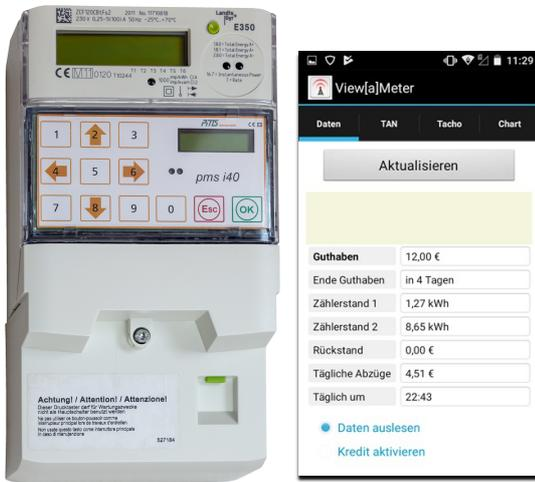
**Abb. 5-3:** Zähler der Firma pms-Elektronik
