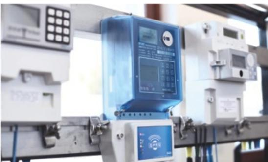
**Abb. 5-4:** Kabellos dialogfähiger Zähler der von der Firma VOLTARIS eingesetzt wird
