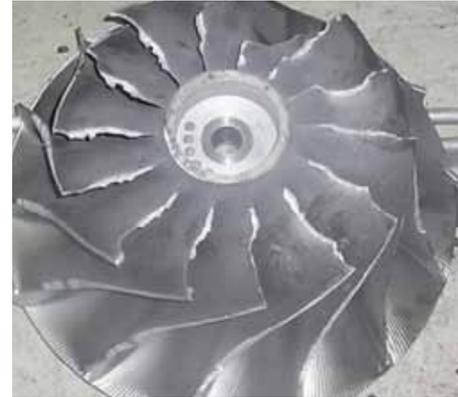
Schaden am Laufrad eines Turboverdichters auf der Kläranlage Mönchengladbach-Neuwerk
