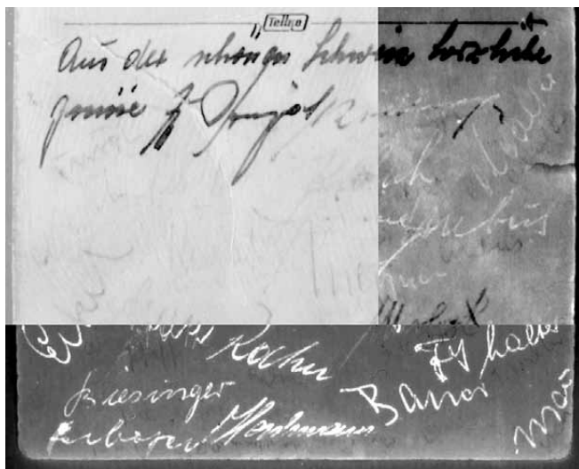
Abb. 4: Oben links: Verblichene Unterschriften unter Tageslicht und nach digitaler Bearbeitung. Die meisten Schriftzüge sind nur erahnbar. Oben rechts: Anregung bei 460 nm (blau) und Betrachtung durch Bandpassfilter 600 nm (orangerot). Die meisten Schriftzüge beginnen schwach zu fluoreszieren. Zwei Unterschriften (Posipal und Morlock) jedoch erscheinen weiterhin schwarz. Unten: Anregung bei 570 nm (gelb) und Betrachtung durch Bandpassfilter 700 nm (rot). Die meisten Schriftzüge fluoreszieren stark. Die Unterschrift von Posipal erscheint weiterhin schwarz. Die Unterschrift von Morlock ist unsichtbar geworden. Am unteren Rand erscheinen erstmals weitere Unterschriften. WM-Postkarte 1954, Privatbesitz.
