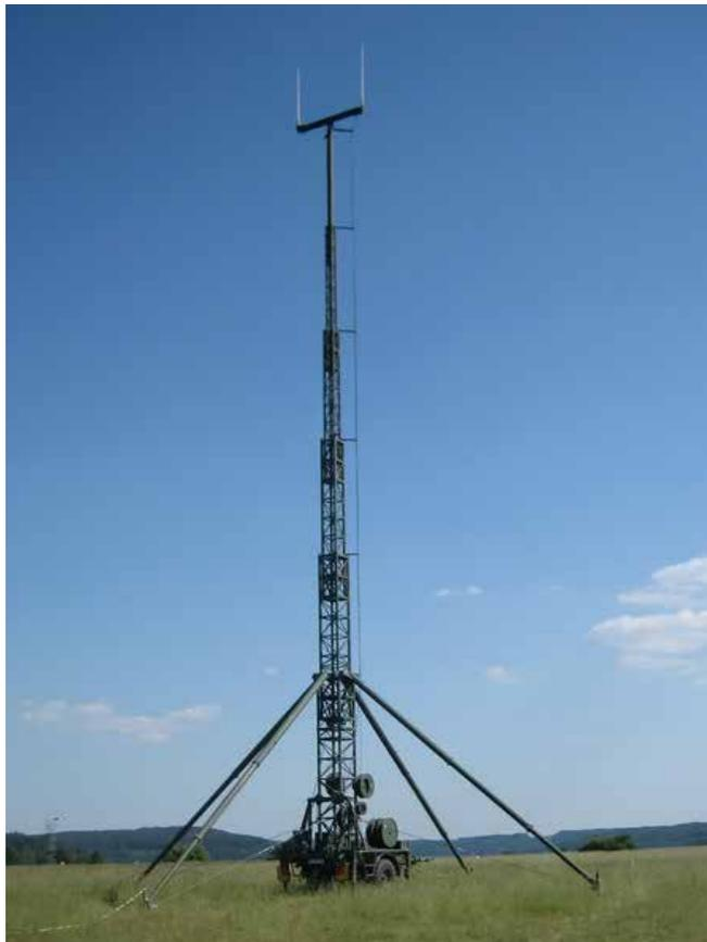
Der fertige FwA-29 (Antennenmast) wird anschließend fernmeldetechnisch durch die Gruppen (hier v.a. Funk) des SG 37/42 – Daten- und Kommunikationstechnik sowie voraussichtlich fahrzeugtechnisch vom TKZ betreut.
