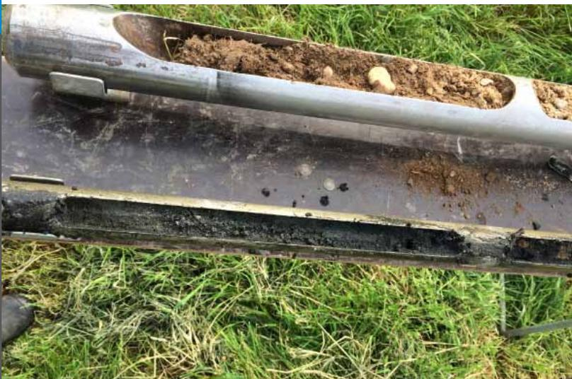
Bodenprofil in Rammkernsonde
