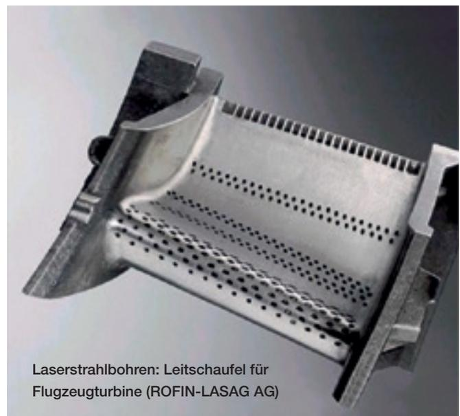
Laserstrahlbohren: Leitschaufel für
