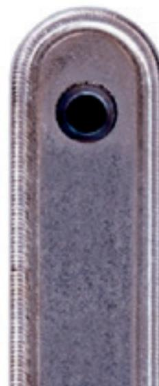
Nahtschweißung eines Batteriepaketes für einen Herzschrittmacher (ROFIN-LASAG AG)
