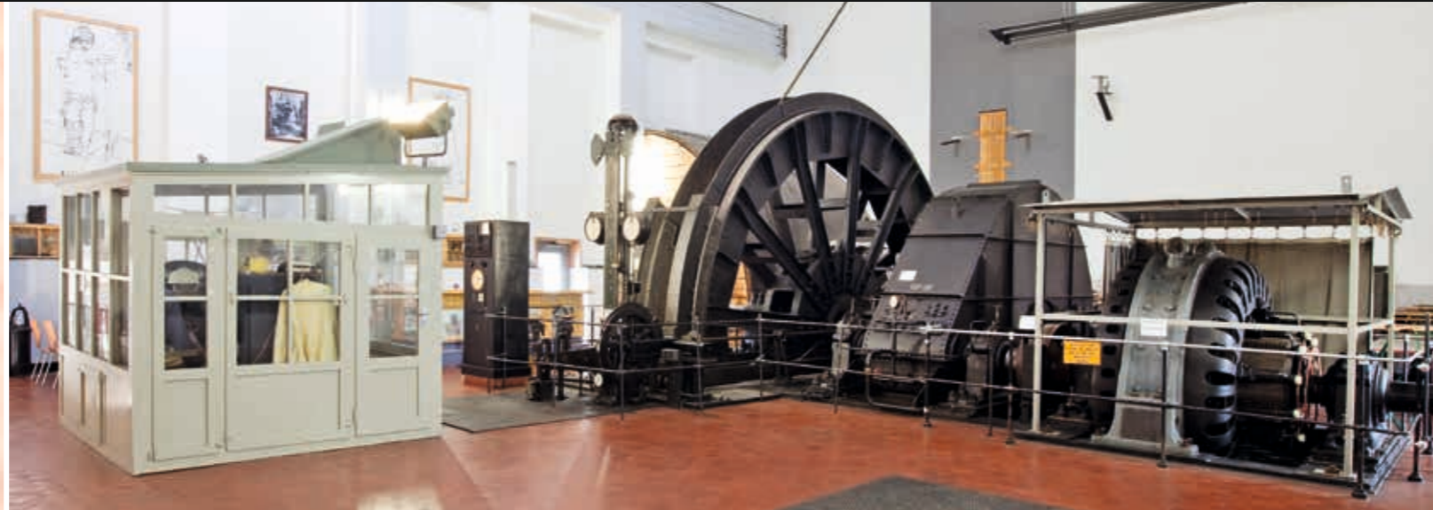
Die Fördermaschine ist über ein Stahlseil mit dem Fördergerüst verbunden.
