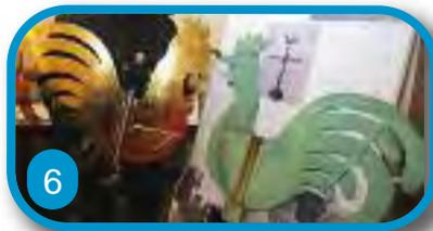
Das Material des alten Hahns war leider so stark korrodiert, dass ein Restaurieren nicht mehr sinnvoll war. Also wurde aus Edelstahl exakt nach dem Vorbild ein neuer Hahn angefertigt (Abb. 6) und in der Malerwerkstatt Epe mit Blattgold belegt.
