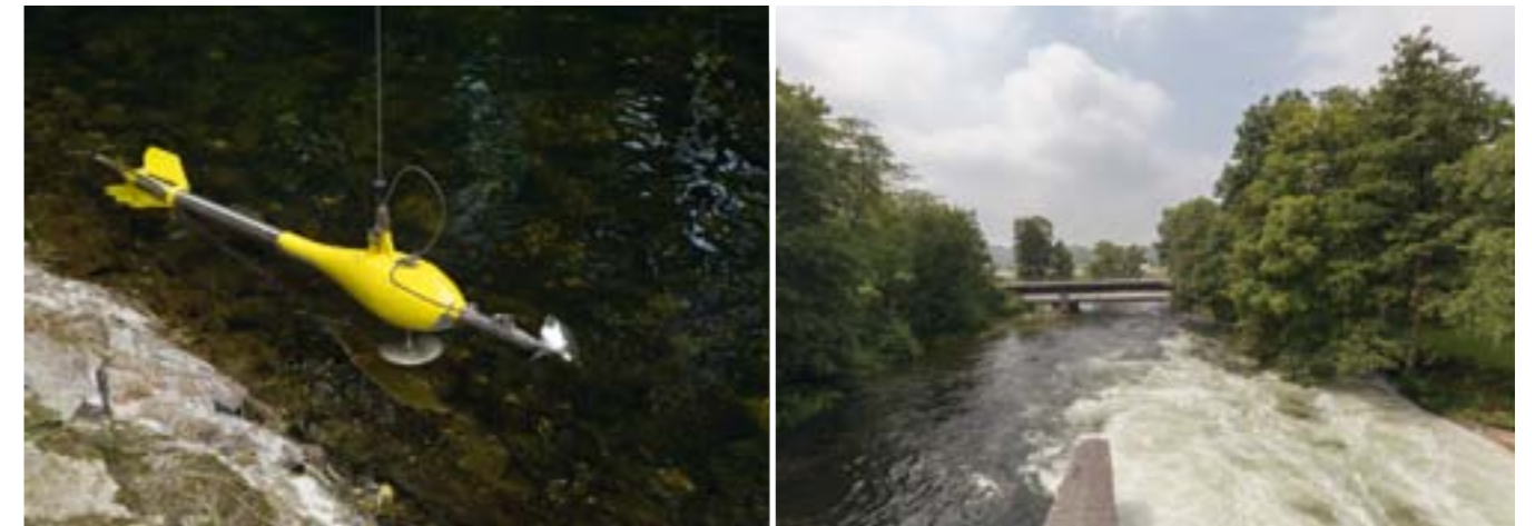
Der Ruhrverband hat die Abflussleistung der Wehranlage unterhalb des Ausgleichsweihers der Möhnetalsperre untersucht. Die Durchflussmessung lässt Rückschlüsse auf die Verhältnisse bei extremem Hochwasser zu.
