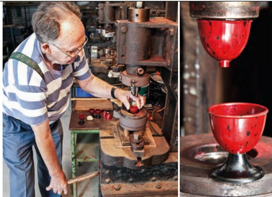
Eierbecher gehören zu den Produkten, die bei Vorführungen im Schleiper Hammer „live“ aus dem pulverförmigen Grundstoff unter Hitze und Druck geformt werden. So entsteht für die Besucher zugleich ein beliebtes Mitbringsel.
