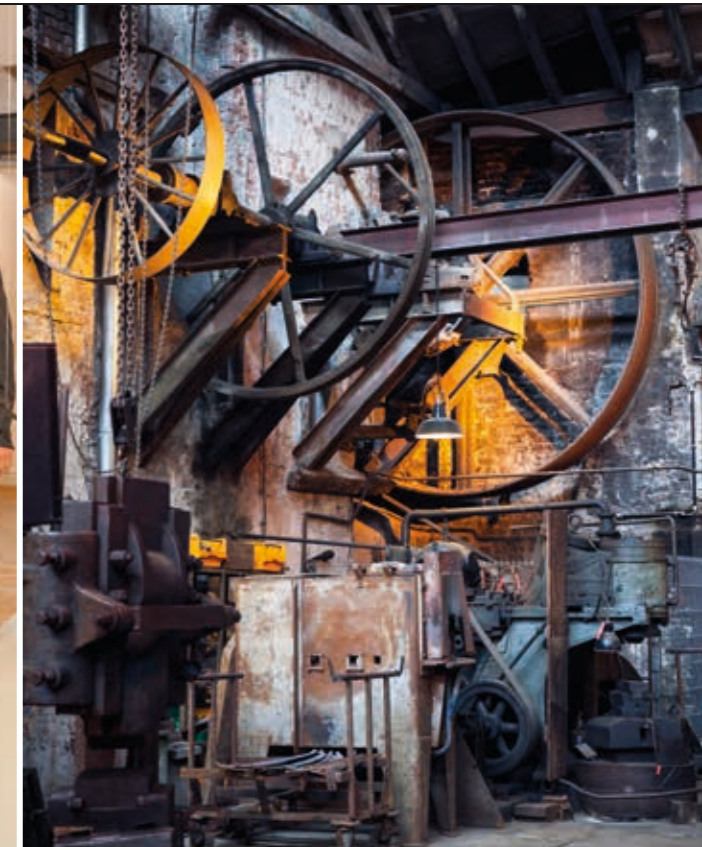
Links: Gisela Schäperclaus, Jörg Heyn, Renate Steudel, Bernd Bornewasser, Wilhelm Matthies, Bernhard Marewski und Dagmar Faust vom Förderverein Freudenthaler Sensenhammer. Rechts: Die großen Antriebsräder der Transmission übertrugen die Wasserkraft der Dhünn.
