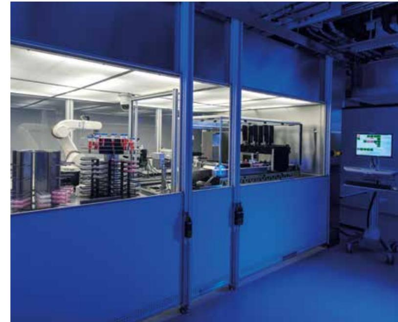
StemCellFactory – eine automatisierte Roboterstraße zur Herstellung und Differenzierung von induziert pluripotenten Stammzellen
