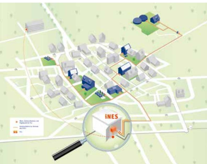
Das Konzept der dezentralen Netzautomatisierung umfasst die Installation einer intelligenten Steuerungstechnik in der Ortsnetzstation. Diese kommuniziert mit geschickt positionierten Sensoren und Aktoren im Netz. Auf diese Weise wird stets der sichere Betrieb des Netzes gewährleistet.
