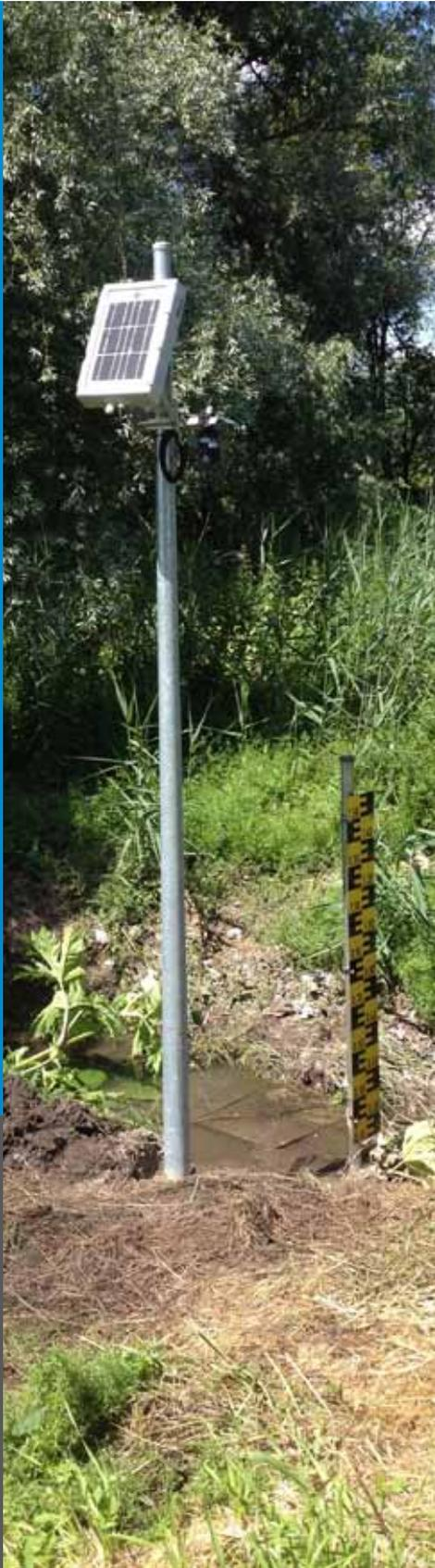
lungsanlage sowie weitere relevante Daten der Betriebsstelle via GPRS an den Server eines externen Dienstleisters übertragen. Diese werden vom Niersverband mit dem Messdatenmanagementsystem für die Berichte der SÜWVO-Abw aufgearbeitet.
