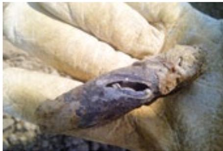
Durch die Einwirkung der Trennscheibe kam es zu einer Öffnung im zylindrischen Teil des Granatkörpers und aufgrund der eingetretenen mechanischen Belastung zu einer Teildeflagration (einem schnellen Abbrand) des Sprengstoffes, wodurch der Bauarbeiter leicht im Gesicht verletzt wurde. Nach einer Sofortbehandlung im Krankenhaus konnte der Mann noch am selben Tag
