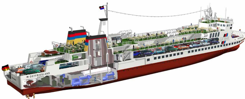
Ein Modell der erneuerten MS Ostfriesland. Blau markiert ist die neue Motorenanlage zu erkennen. (Grafik: AG EMS)
