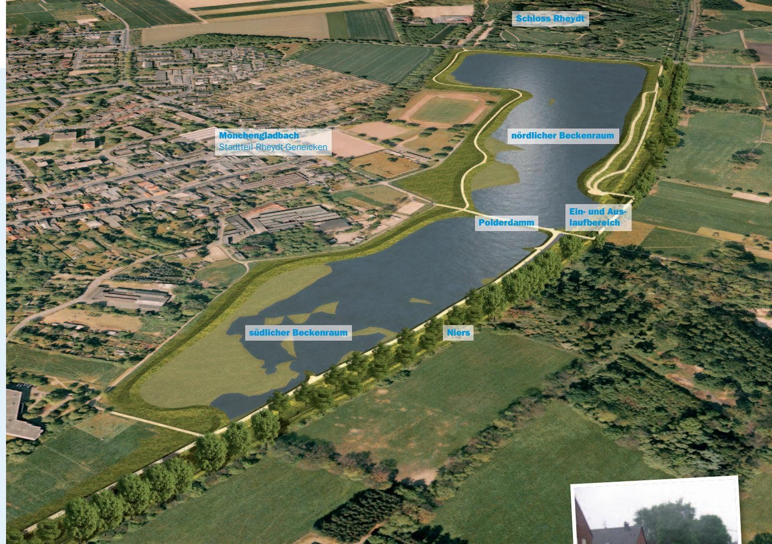
Meist wird das Hochwasserrückhaltebecken als Grünfläche zu erleben sein. Bei Hochwasser wird es teilweise eingestaut und zeitversetzt wieder entleert. Erst bei außergewöhnlichen Regenereignissen kommt es zu einer vollständigen Füllung beider Beckenteile. Über eine gezielte Notentlastung in die Niers wird sichergestellt, dass es nicht zum Überlaufen an anderen Stellen entlang des Hochwasserrückhaltebeckens kommt.
