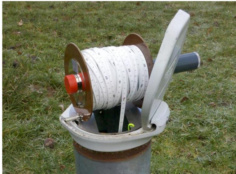
Abb. 17: Grundwasserstandsmessung (Quelle: LANUV NRW).
