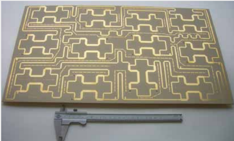
Butler-Matrix-Leitungsnetzwerk zur Speisung von Sende-Spulen eines 7-Tesla-Magnetresonanz-Tomographen.
