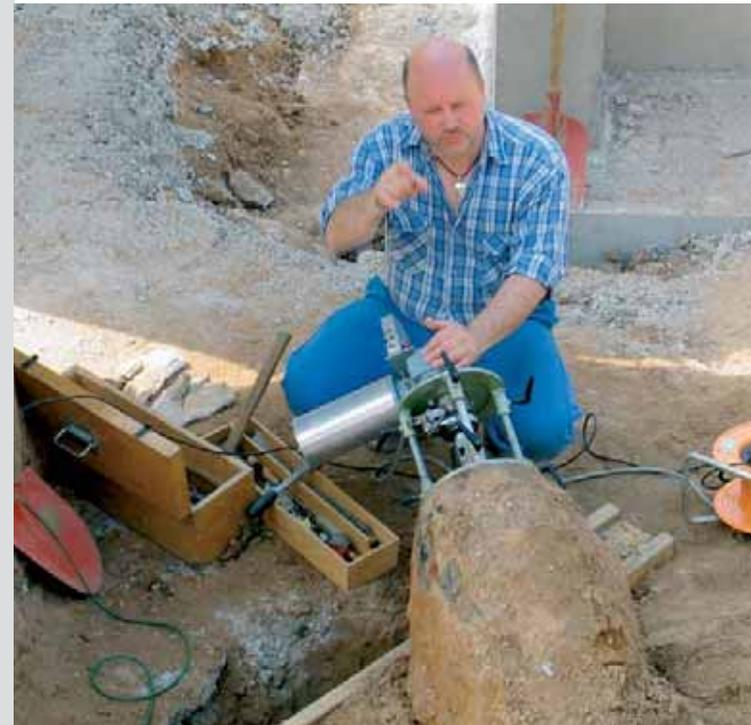
Vorbereitung einer Fern-Entschärfung und Anbau des Ausdrehgerätes am Boden der Bombe.
