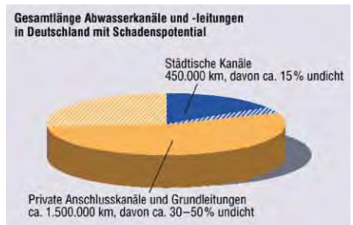
Abb. 1: Anteil undichter Abwasserkanäle in Deutschland
