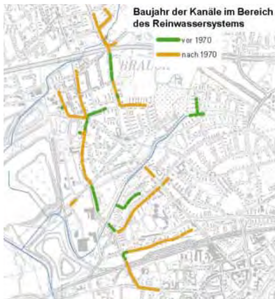
Abb. 2: Keine Systemvernetzung aufgrund langer Restnutzungszeiten der Abwasserkanäle
