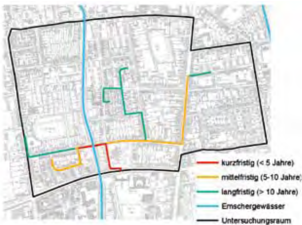
Abb. 4: Beispiel Umsetzungsprioritäten Reinwassersystem
