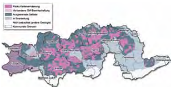
Abb. 6: Risiko der Kellervernässung durch Grundwasseranstieg
