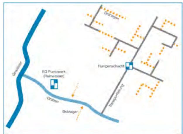
Abb. 3: Systemskizze Reinwassersystem im Emschergebiet
