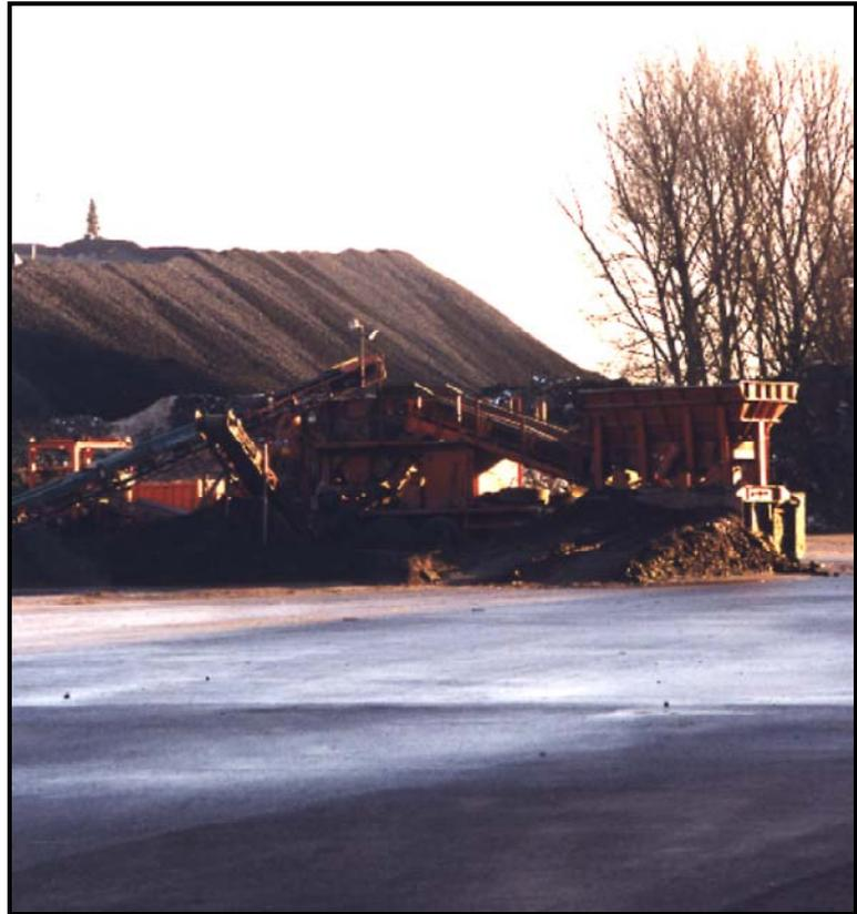
*Vollständige Flächenbefestigung (Asphaltierung) bei einer Bauschutt- und Schlackenaufbereitungsanlage*
