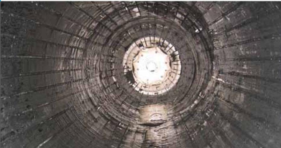
Schlammaustragsbuchse mit hohem abrasivem Verschleiß
