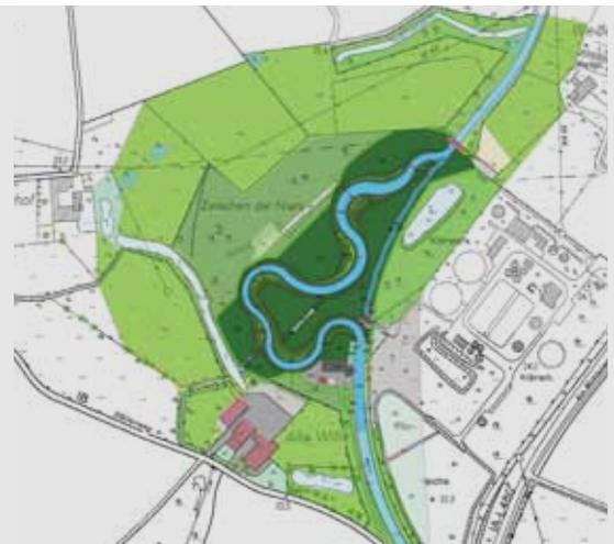
Geldern wird der Abzweig zum Nierskanal verlegt und die Niers in eine neue, sich windende Gewässertrasse umgelegt. Die hierdurch resultierende Laufverlängerung und der damit verbundene Gefälleabbau erlauben die Entnahme des Wehres in der Niers unmittelbar unter dem Abzweig zum Nierskanal. Die Planungen wurden im Jahr 2011 abgeschlossen und die Planfeststellung bei der Bezirksregierung Düsseldorf beantragt.
