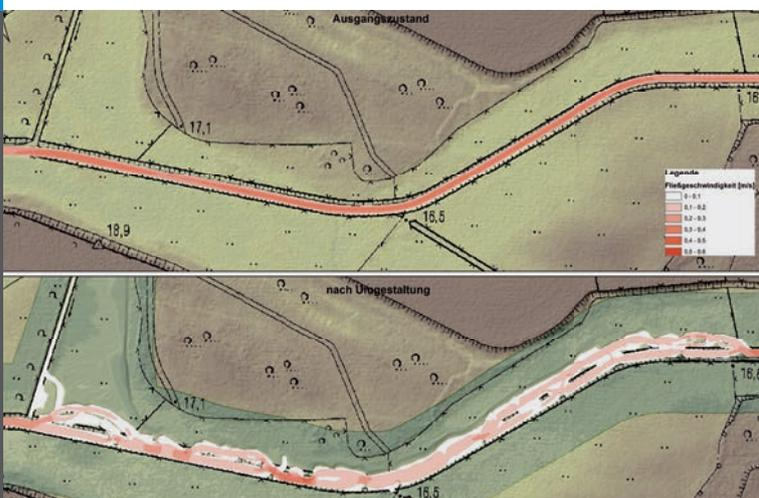
Maximale Wasserspiegellagen bei Belastung mit einer Abflusswelle bis HQ<sub>2</sub>
