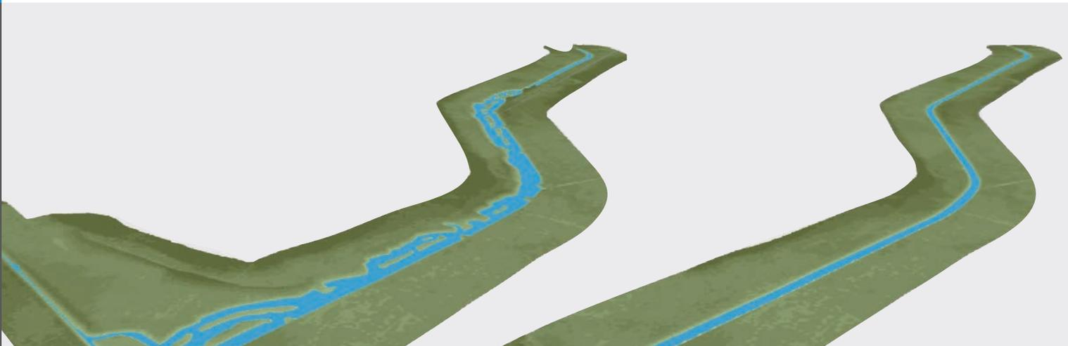
Mit den beiden 2D-Modellen wurden Vergleichsrechnungen vorgenommen, um die Auswirkungen der Umgestaltungsmaßnahme zu untersuchen. Es zeigt sich, dass durch die neue Gewässermorphologie die Fließgeschwindigkeiten gesenkt werden und der Gewässerabschnitt nun über eine deutlich sichtbare Strömungsdiversität verfügt.
