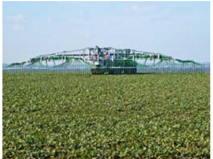
Bild 15.4: Bodennahe Gülleausbringung mit Schleppschläuchen
