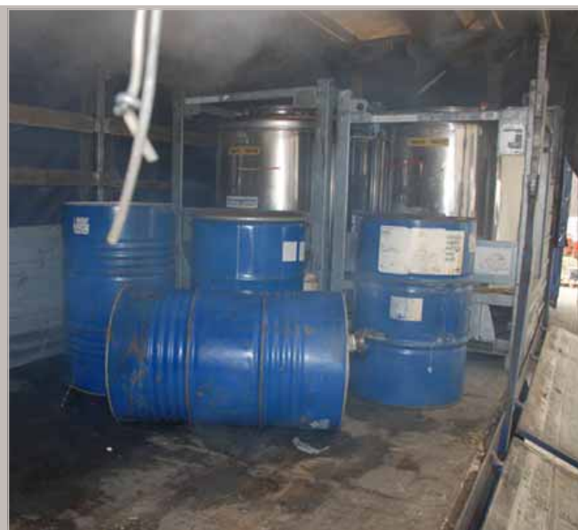
Auf der Ladefläche sind mehrere Behälter undicht.
