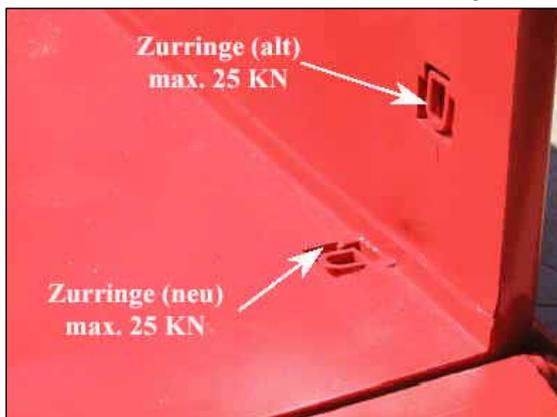
im Bodenbereich 10 zusätzliche Verzurringe zur Ladungssicherung angebracht worden. Die maximale Belastung der Verzurringe beträgt 25 kN (2,5 to) pro Ring.
