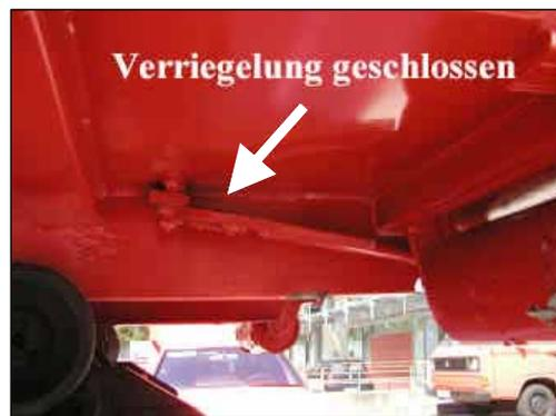
Lage und Stellung der geschlossenen Entriegelung für den Zentralverschluss der Heckklappe
