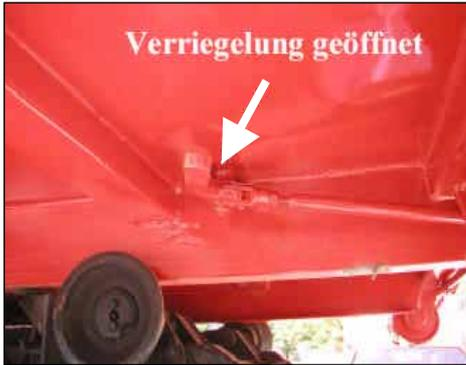
Lage und Stellung der Entriegelung für den geöffneten Zentralverschluss der Heckklappe
