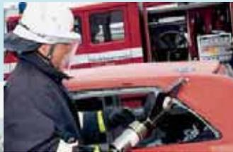
Durchtrennen der C-Säule oberhalb des Gasgenerators.
