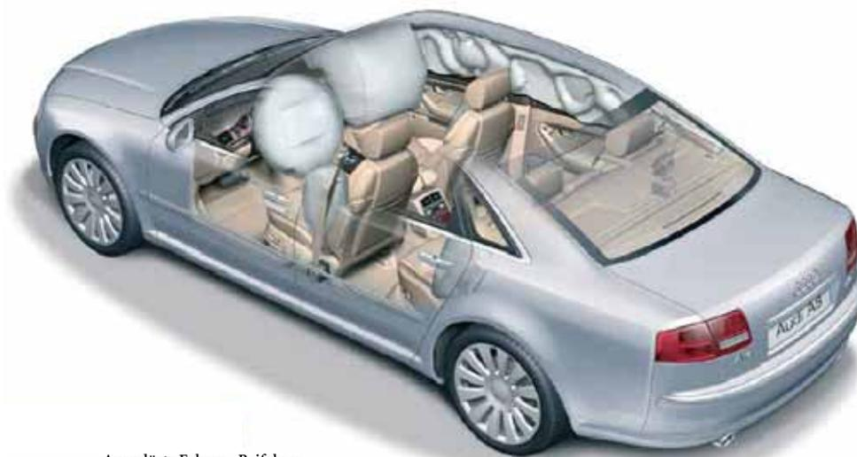
Ausgelöste Fahrer-, Beifahrer-, Seitenairbags und Kopfairbags am Beispiel eines Audi A8
